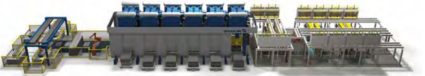
Pressenlinie mit ServoDirekt Technologie und automatischer Fertigteilstapelanlage.
