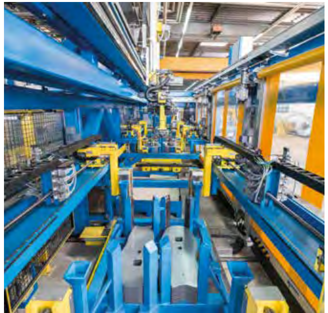
Feeder-Beladestation mit Platinenvereinzellung.
