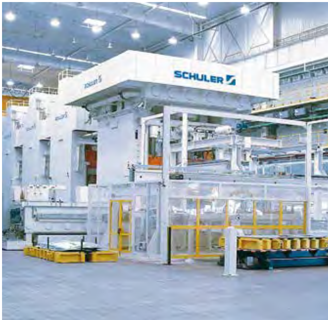
Hybridpressenlinie mit hydraulischer Kopf- und mechanischen Folgepressen.
