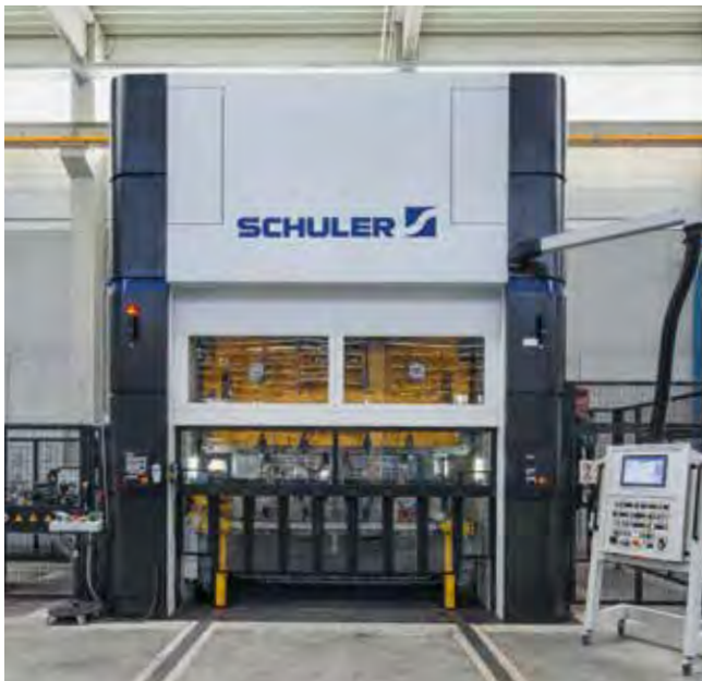
Servopresse in Monoblockbauweise mit 400 kN Presskraft.
