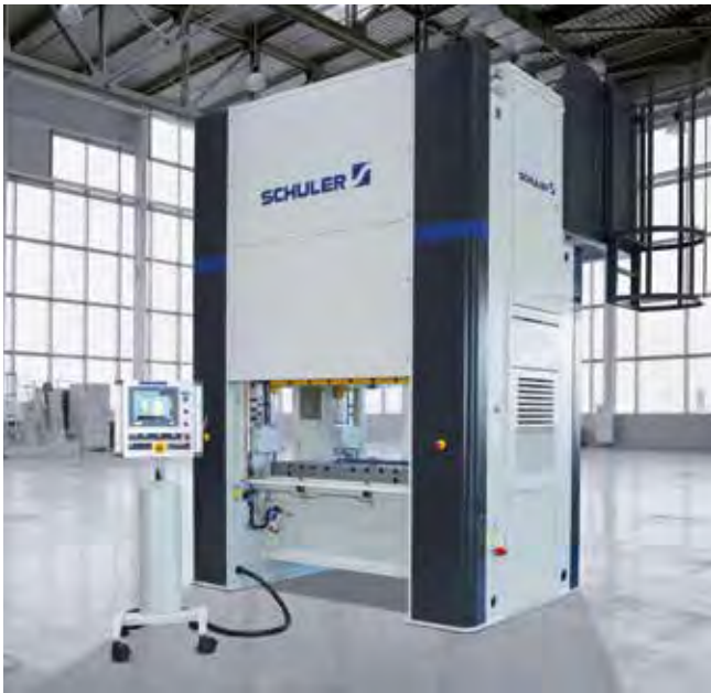
Schnellstanzautomat mit bis zu 300 Hieben pro Minute.
