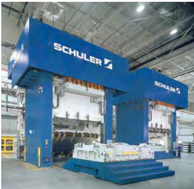
Multicurve-Pressen mit Fahrtisch und Werkzeugwendevorrichtung.
