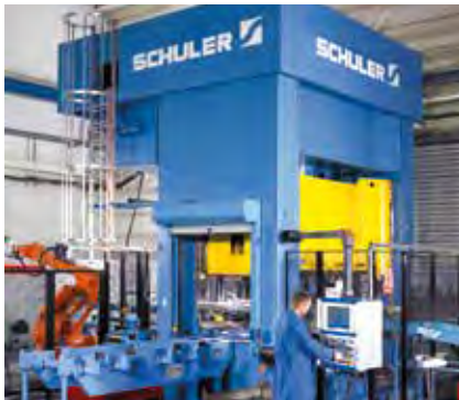
Hydraulische Presse zur Fertigung von Seitenschwellern und Dachspriegeln.
