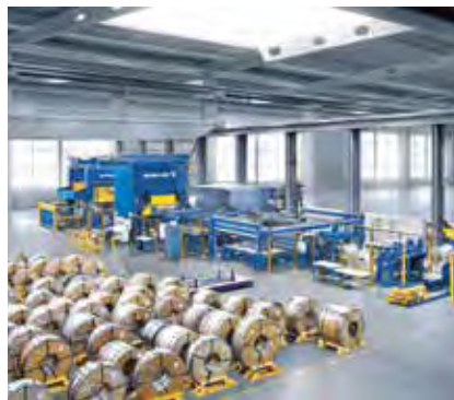
Vollautomatisches Fertigungssystem zur Herstellung von Wärmetauscherplatten.
