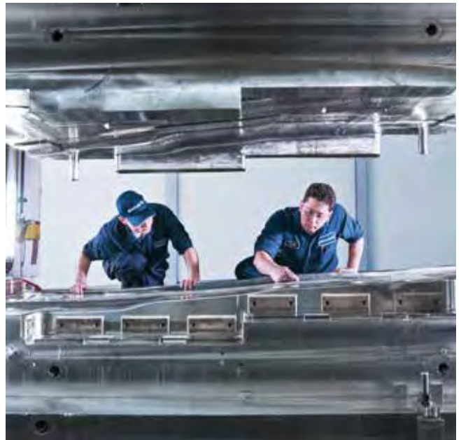
Innenhochdruckumformung von Dachrahmen.
