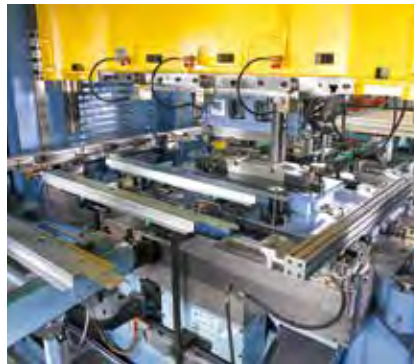
Die maximale Ausbringungslleistung der Anlage beträgt 12 Hube/Minute.
