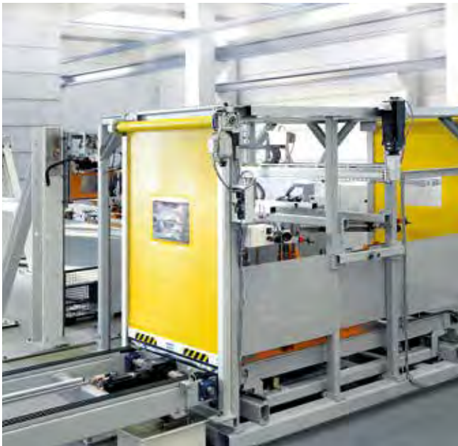
Platinenlader mit Transfersystem zum Entstapeln der Platinen.
