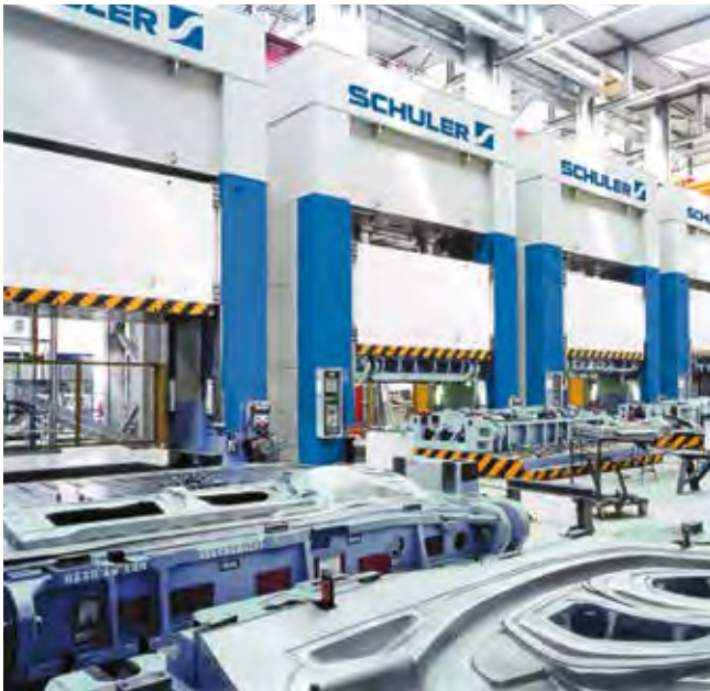
Tryout-Zentrum mit hydraulischen Tryout-Pressen.
