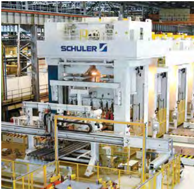
Mechanische Highspeed-Pressenlinie mit Crossbar Feeder-Automation.
