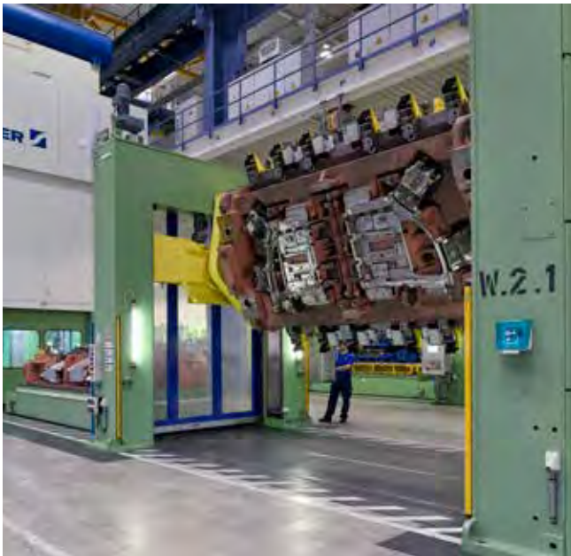
Werkzeugwender zum einfachen Drehen von Oberwerkzeugen.
