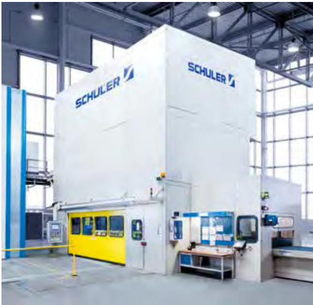
Hydraulische Transferpresse. Presskraft: 25.000 kN.
