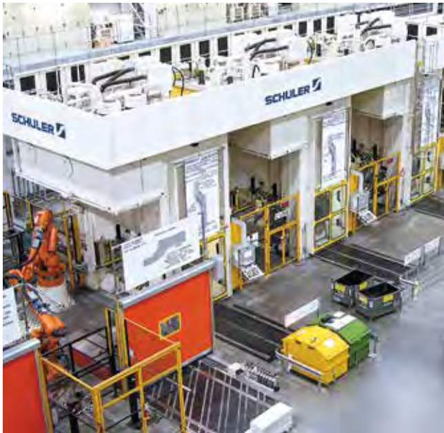
Hydraulische Pressenlinien zur Herstellung von Aluminiumbauteilen.
