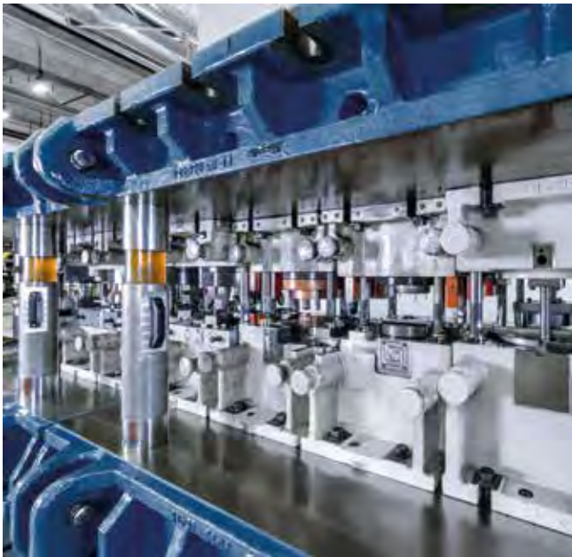
Transferwerkzeug für die Herstellung präziser Getriebeteile.
