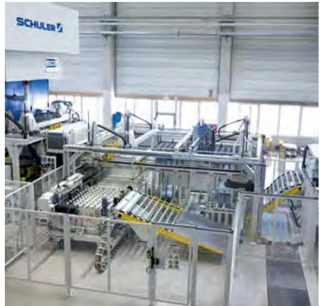
Integrierte Systemlösung. Platinenlader und Bandanlage an einer Servopresse. Presskraft: 16.000 kN.
