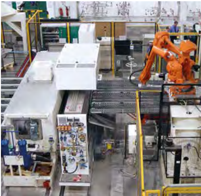
Platinenwaschmaschine, Beöler und Beladeroboter vor hydraulischer Pressenlinie zur Herstellung von Aluminiumbauteilen.
