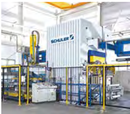
Hydraulische Prägepresse. Presskraft: 25.000 kN.
