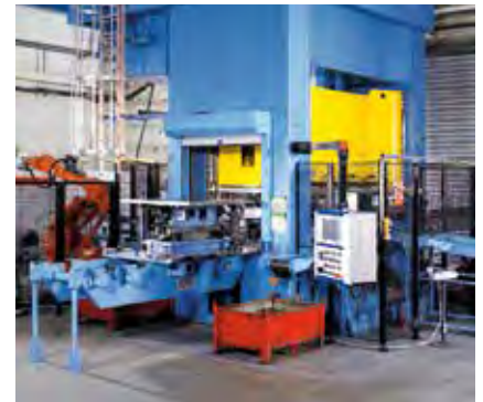
Halbautomatischer Werkzeugwechsel in 15 Minuten.
