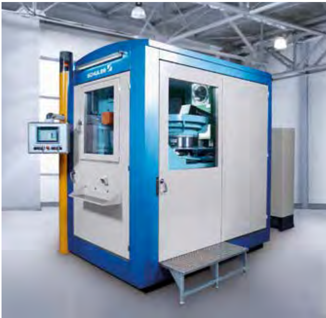
EMKH 300 mit Schallschuttkabine zur Weiterverarbeitung von Scheibenrohlingen – gefertigt auf einem BMK-Schnellstanzautomaten.
