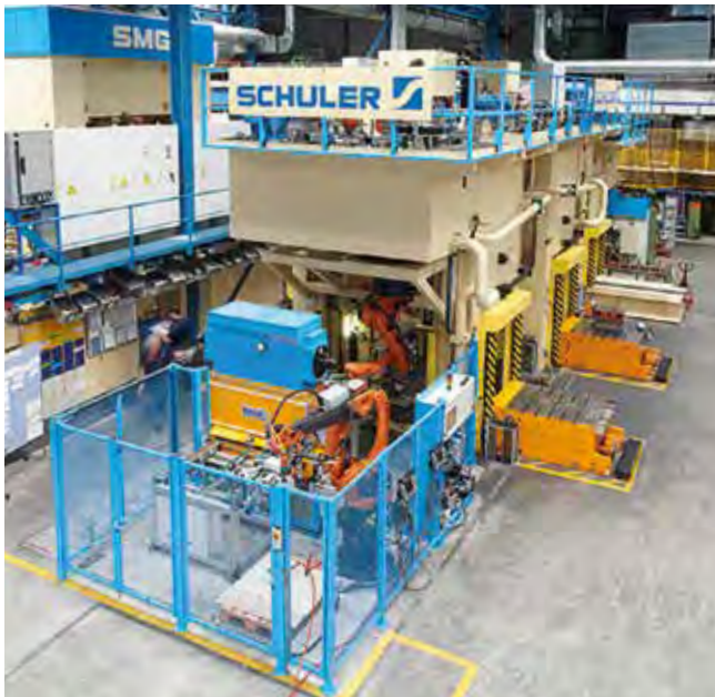
Automatisierte hydraulische Pressenlinie zur Fertigung von Edelstahlspülbecken.
