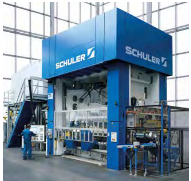
Freie Programmierung der Stößelbewegungskurven bei einer Servopresse in Monoblockbauweise mit 8.000 kN Presskraft.
