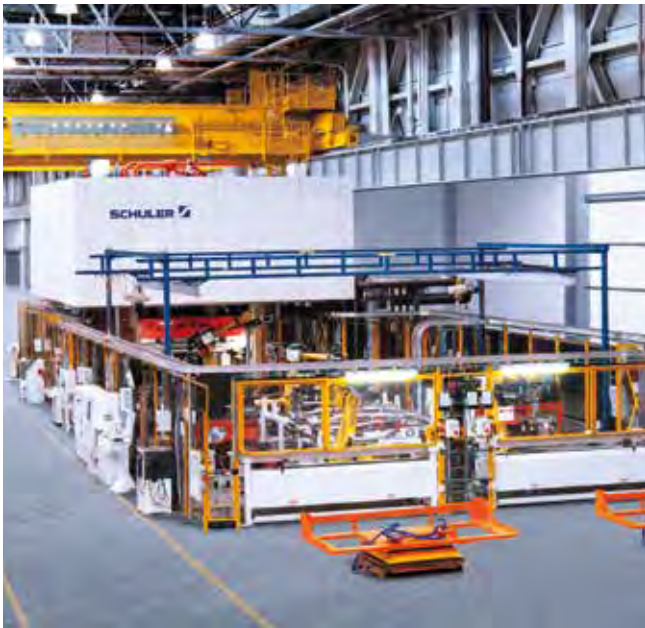
Automatisierte IHU-Anlage eines amerikanischen Automobilherstellers.
