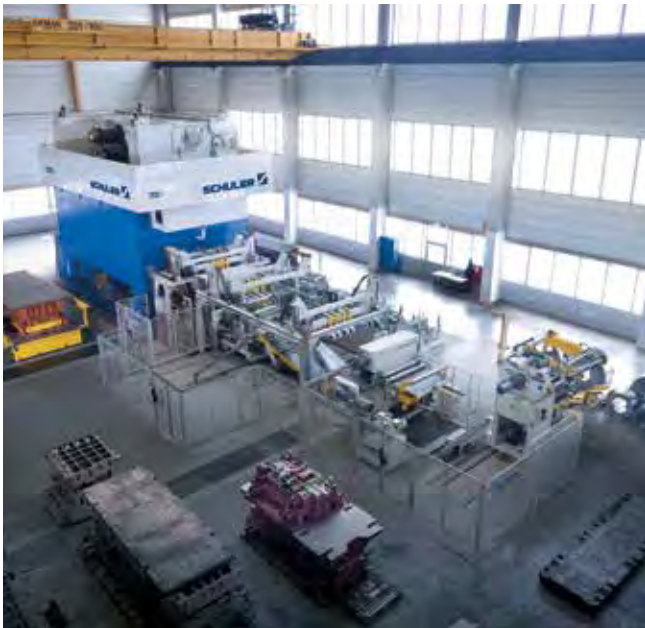
ServoDirekt-Pressen zur Kaltumformung hochfester Stähle.
