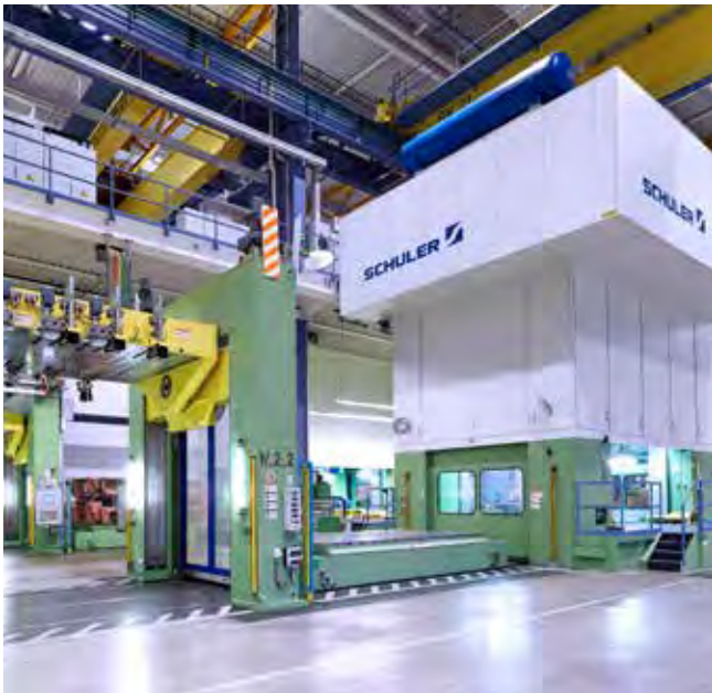
Tryout-Systeme ermöglichen eine höchst effiziente Werkzeugeinarbeitung.
