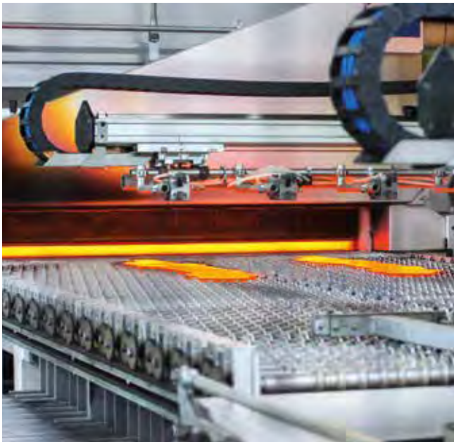
Formhärten von Sicherheitsteilen in Großserie.
