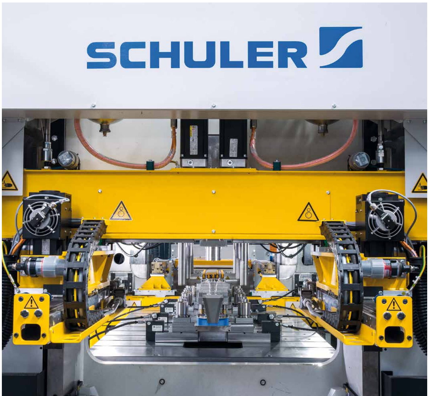
Drei-Achs-Transfer »ProTrans« mit Servoantrieb.
