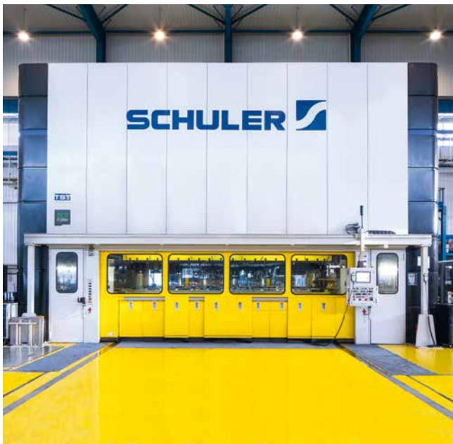
Transferpresse mit TwinServo Technologie.
