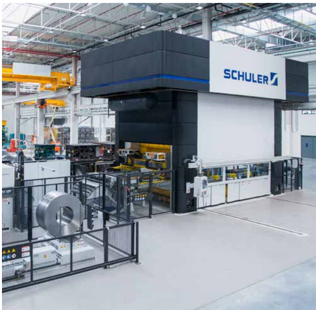
Servopresse in Zugankerbauweise.
