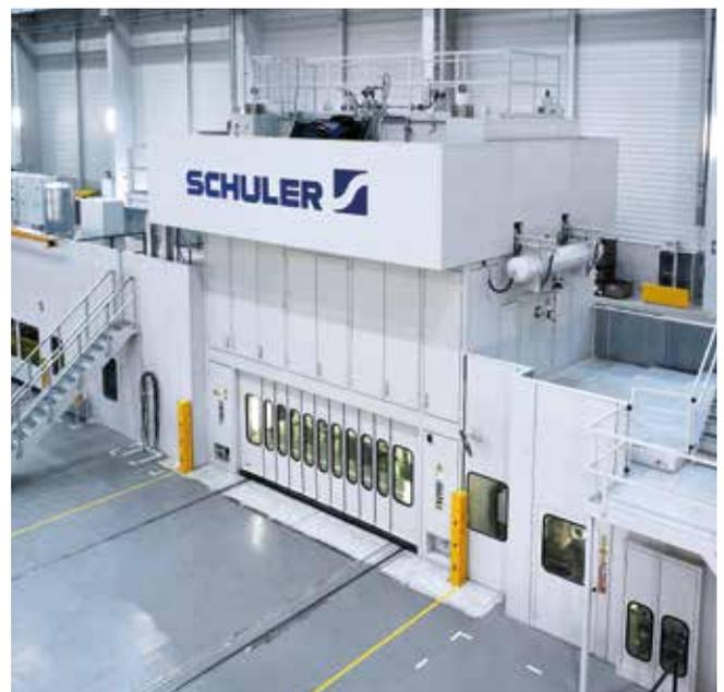
Moderne Platinenschneidanlagen ermöglichen – ebenso wie Querteilanlagen – die Verarbeitung eines breiten Materialspektrums inklusive Aluminium.
