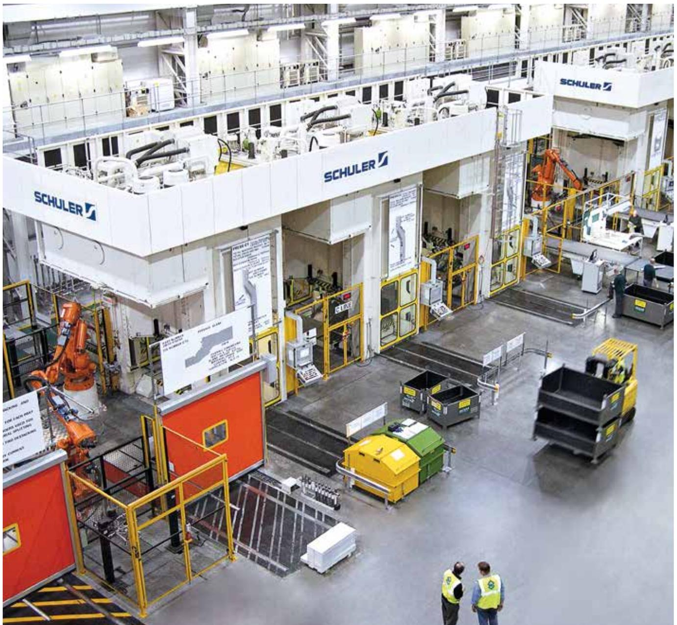
Hydraulische Pressenlinien zur Herstellung von Aluminiumbauteilen.
