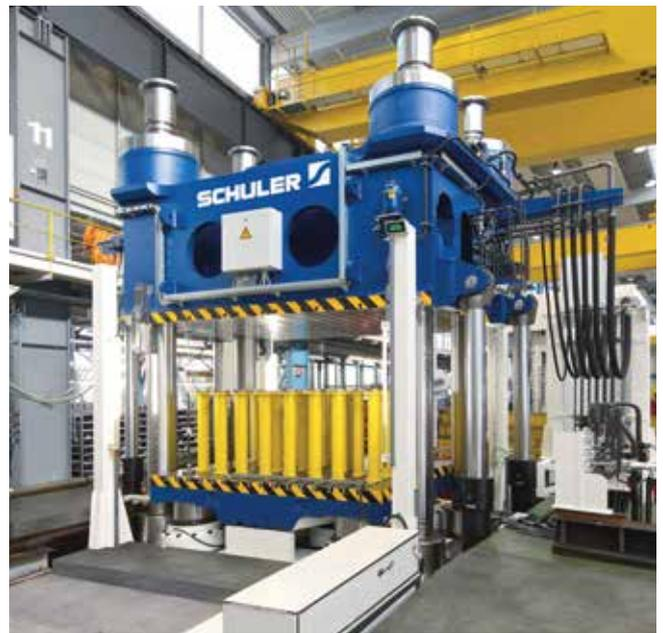
Hydraulische Kurzhubpresse zur Verarbeitung faserverstärkter Kunststoffe.
