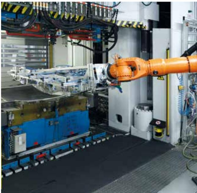
Roboterautomatisierte Serienfertigung von Carbondächern.
