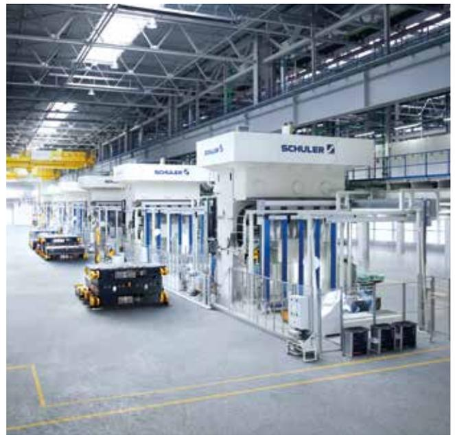
Hydraulische Kunststoffpressen für die Großserienfertigung.
