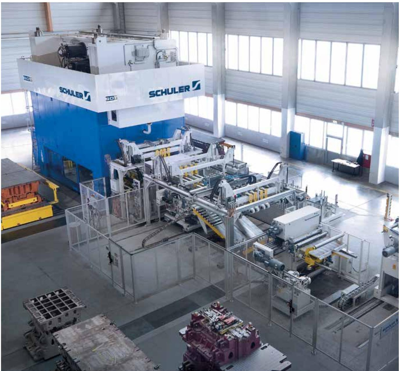
Servopresse in Zugankerbauweise mit Platinenlader-Bandanlagen-Kombination.
