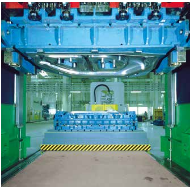
Flexible Abdeckung über dem Pressentisch.
