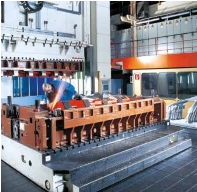
Komfortabler Werkzeugwechsel mit Fahrtischen.
