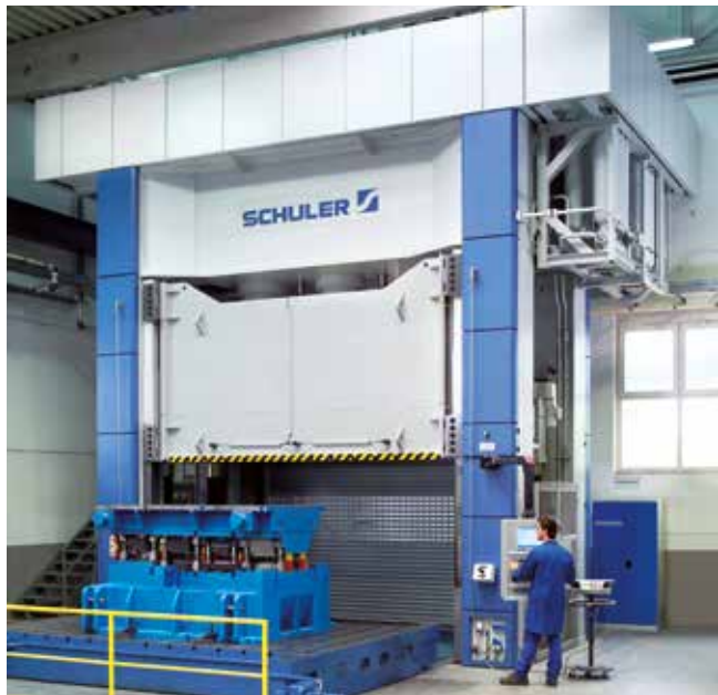
Hydraulische Tryoutpressen im Werkzeugbau.
