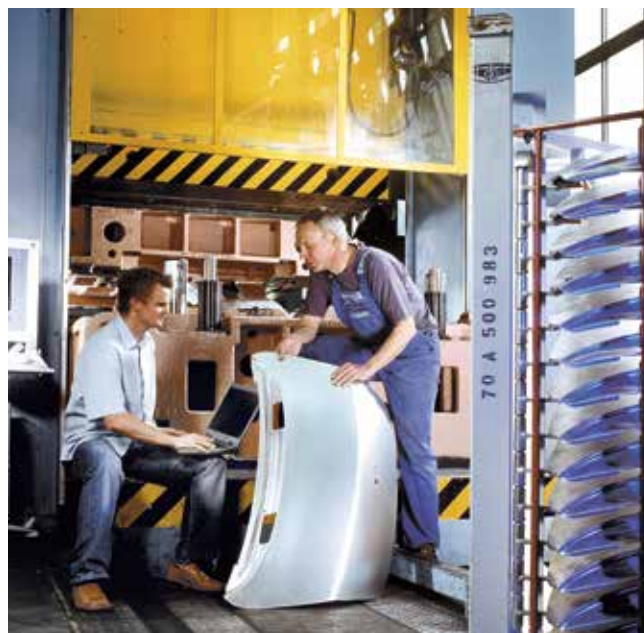
Hydraulische Tryoutpressen reduzieren kostenintensive Stillstandzeiten.
