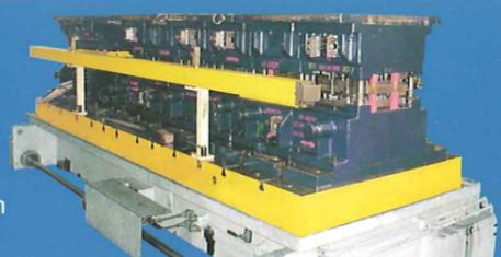
Der Einbau der Greif- und Hebeeinheiten erfolgt in den Seitenständern in stehender oder hängender Ausführung. Damit wird sichergestellt, dass das Vormaterial – Band oder Platine – sowie die Fertigteile problemlos und ohne Hindernisse auf dem kürzesten Wege, zu- und abgeführt werden können. Robuste Greiferschienenkupplungen in der bewährten
