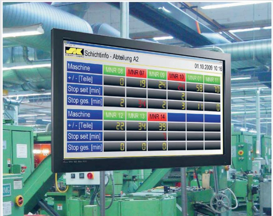
**Andon** ist eine in Japan entwickelte Methode, um Abläufe und Funktionen von Produktionsanlagen transparent und für jedermann einsehbar zu machen.
